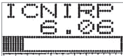
Рис. 4. Вывод на дисплей SPECTRAN® норм воздействия как в процентном виде, так и в виде гистограммы
