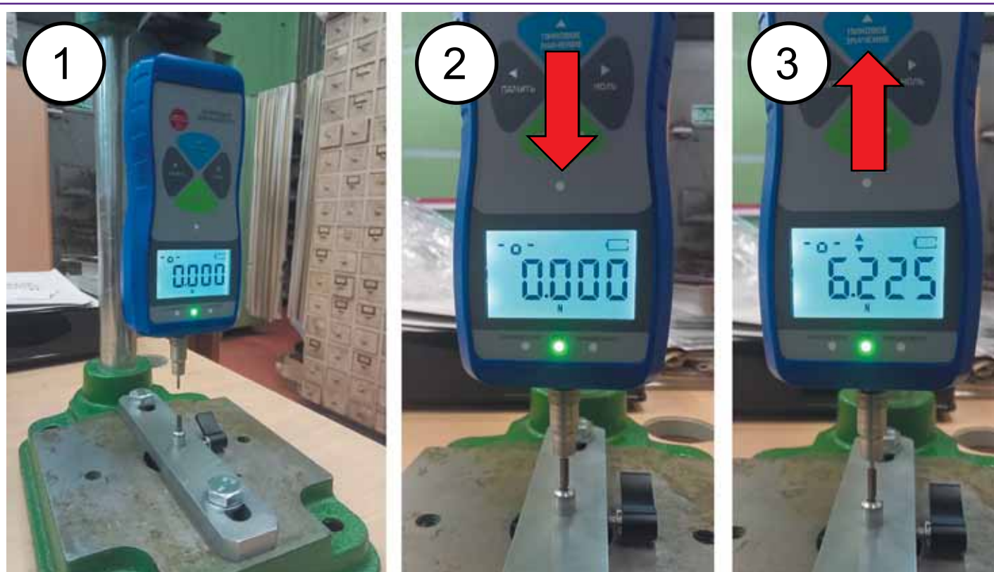
Рис. 5. Контактметр и этапы его работы
