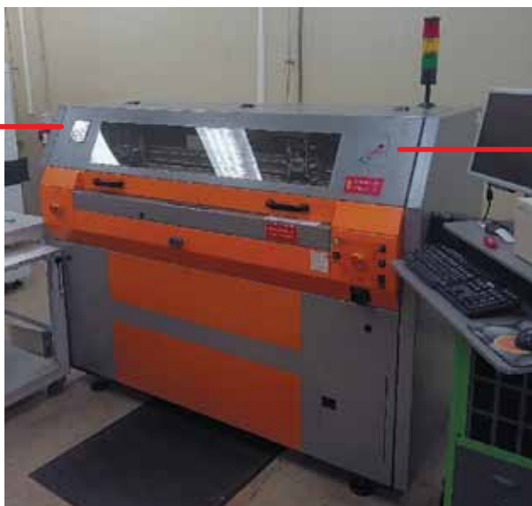
Рис. 1. Установка электрического контроля с летающими щупами ATG A5
