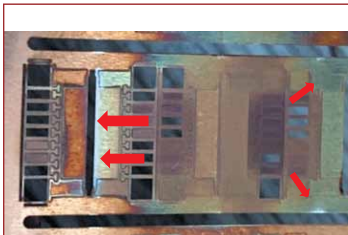
Рис. 6. Места контактов с ламелью отмечены стрелками
