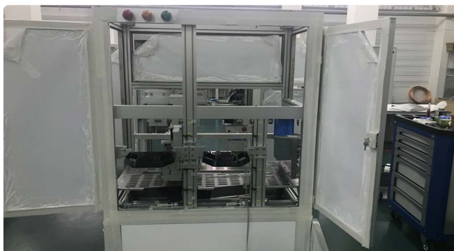
Установка плазмо-химического удаления фоторезиста P200 Диаметр пластин 100 и 200 мм
