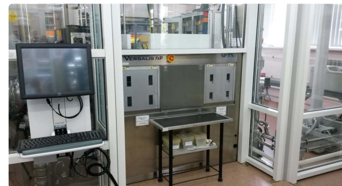
Кластер Versalis fxP Модули Rapier, PVD, RHSE Диаметр пластин 100 и 200 мм
