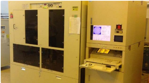
Степпер NSR-2205i12D Минимальный размер 0,28 мкм Диаметр пластин 100 и 200 мм
