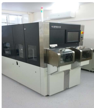
Установка утонения пластин DTG 8440, «Тайко» утонение пластин диаметром 200 мм Диаметр пластин 100 и 200 мм
