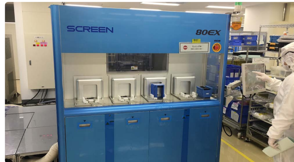
Установка нанесения, проявления и сушки фоторезиста SK 80EX Диаметр пластин 100 и 200 мм
