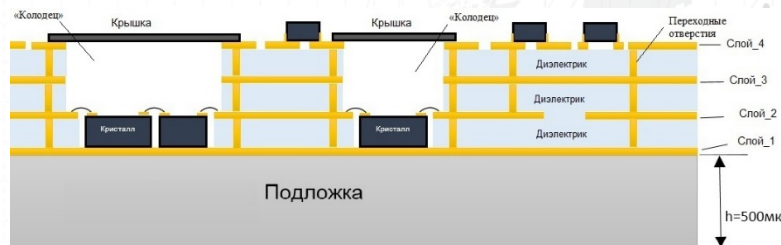
Общий вид топологии 5-слойной коммутационной платы модуля МШУ
