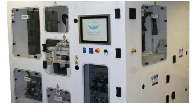
Установки химической обработки пластин Geneve Model и Dubai Model Диаметр обрабатываемых пластин 100 и 200 мм
