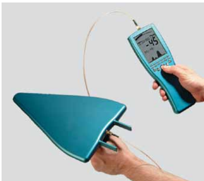
Рис.1. Антенна HyperLOG 30180, подсоединенная к анализатору спектра Spectran
